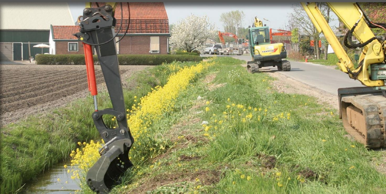
PARTICOLARMENTE ADATTO A SVOLGERE OPERAZIONI DOVE IL RAGGIO DI AZIONE DELLA MACCHINA IN CONFIGURAZIONE STANDARD NON È SUFFICIENTE. IL BRACCIO PROLUNGA È FORNITO COME "QUASI MACCHINA" SECONDO L'ALLEGATO II-B DELLA DIRETTIVA 2006/42/CE. DOVRÀ ESSERE DICHIARATO CE CONFORME DOPO L'ASSOCIAZIONE CON LA MACCHINA BASE, PRIMA DELLA MESSA IN SERVIZIO.
