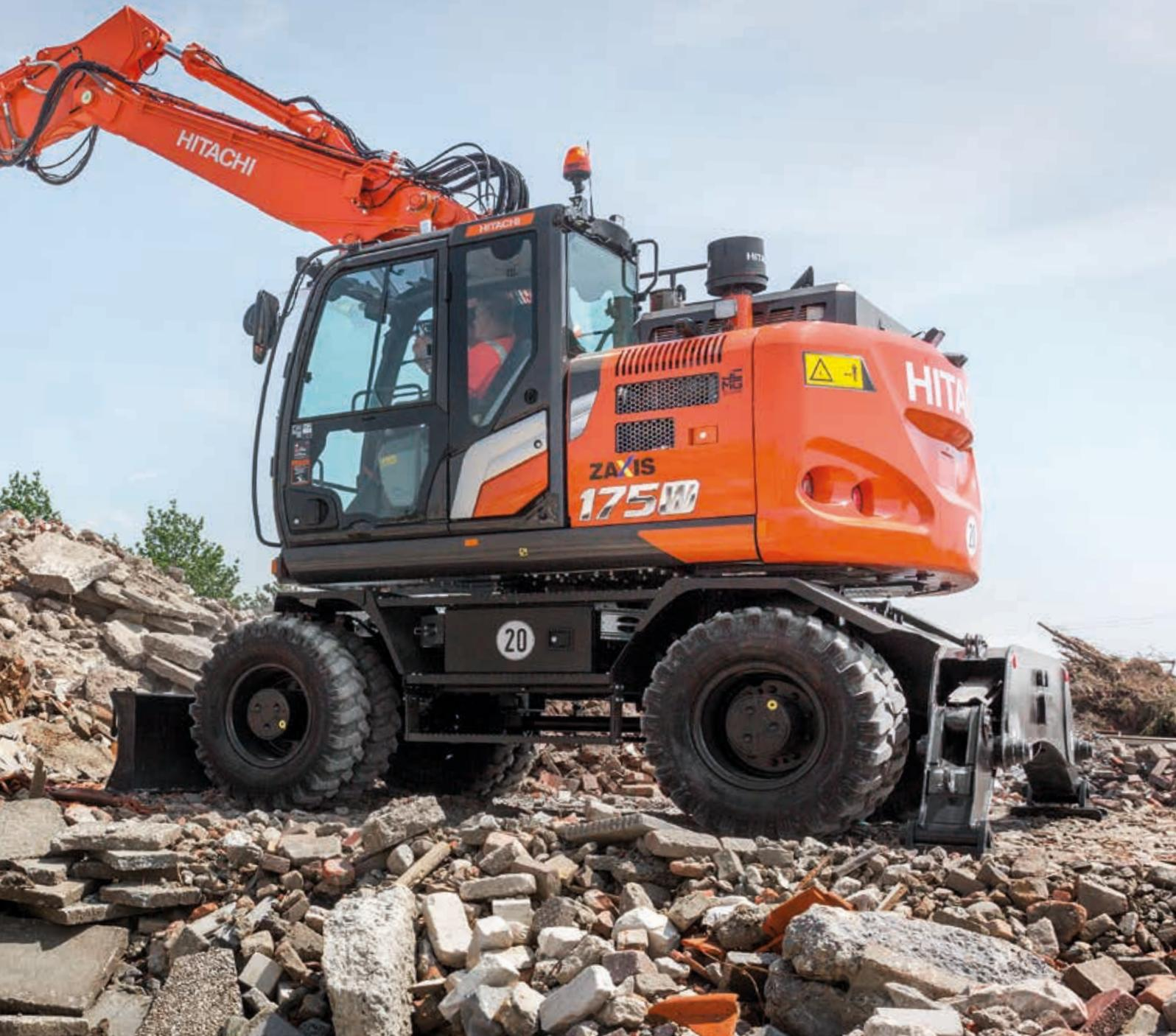
Il circuito idraulico HIOS V fa aumentare la velocità di avanzamento e riduce il consumo di carburante.
