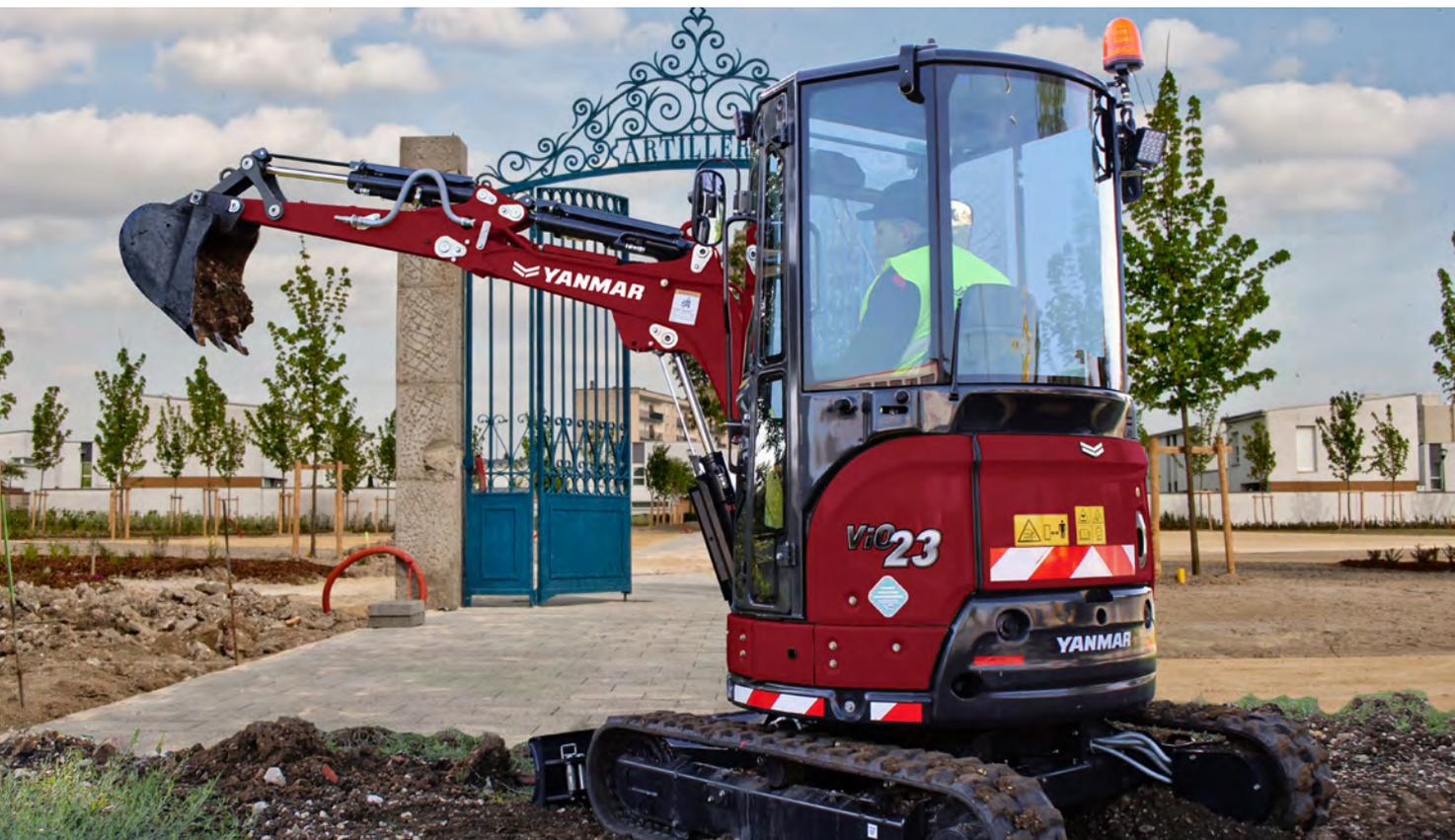
Il modello ViO23-6 offre prestazioni eccezionali per una macchina della sua classe. La profondità di scavo di 2450/2655 mm\* e le forze di scavo pari a 17,5 kN (benna) e 13,1 / 10,6 kN\* consentono di lavorare in modo rapido ed efficiente anche nelle condizioni più gravose.
