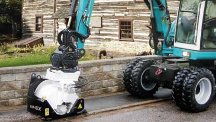
PLB 450. Fresatura marciapiede.
